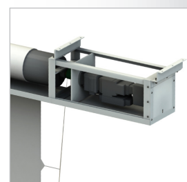
Speciální systém pohonu a uložení nosné trubky pro maximální bezpečnost provozu
